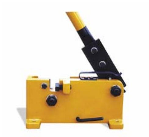
Ножницы имеют ручной привод. Разрезают прутки круглого сечения диаметром до 32 мм и квадратного сечения до 28x28мм, полоса размером до 40x14мм.
